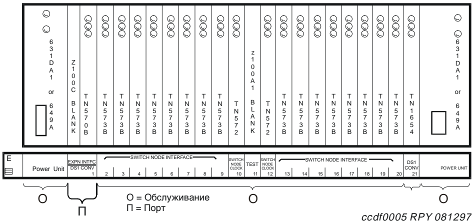
Рис. 40. Платодержатель коммутационного узла J58890SA — вид спереди
